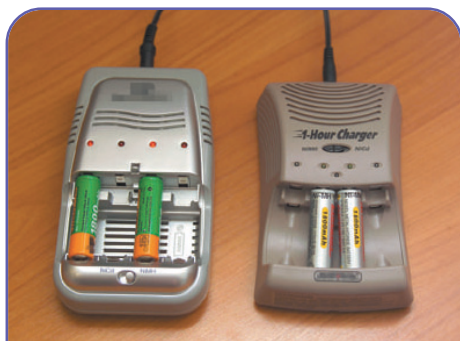
此兩款充電器設有4組獨立充電線路及指示燈，用者可清楚知道每粒充電電池的充電情況
