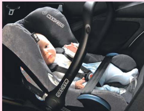
後向安裝：安全座椅方向與駕駛方向相反，用於初生至13公斤以下的嬰孩；在正面撞擊中的整體表現較好
