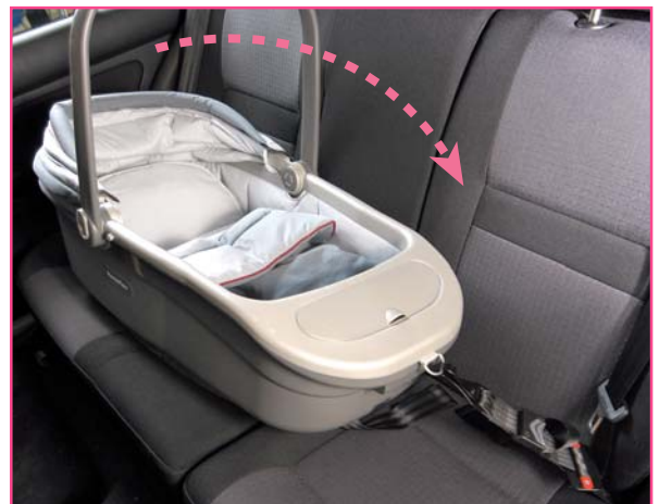
手提嬰兒臥床對象是初生至10公斤以下的嬰孩，橫向安裝於汽車後排座位，讓嬰兒臥睡，但佔用位置較大；在正面及側面撞擊中表現較遜色。安裝時應盡量令嬰兒頭部靠向汽車中間，以防遇到側面撞擊時，嬰兒頭部太接近撞擊點
