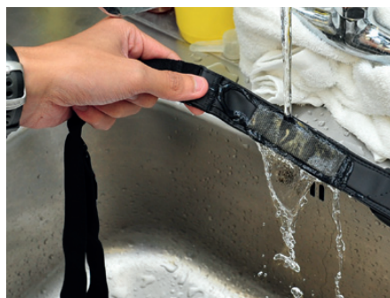
▲使用前須以清水弄濕胸帶上的電極。
