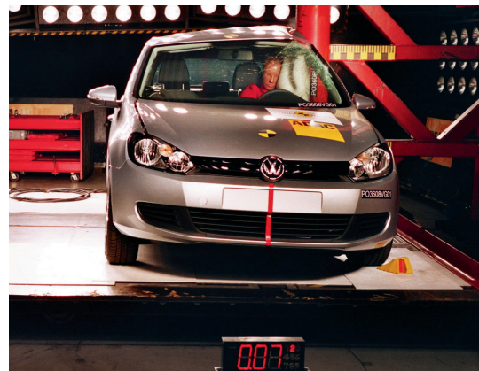
▲撞柱測試 - 測試頭部車側氣囊的安全表現。
