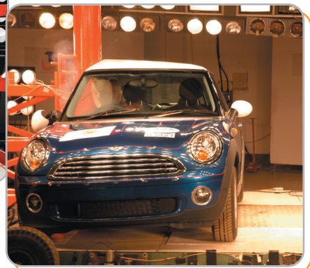
「撞柱測試」- 測試頭部車側氣囊的安全表現。
