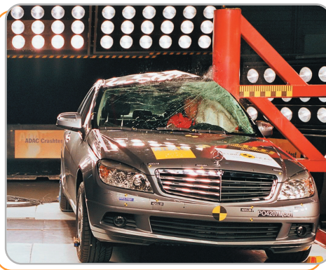
「撞柱測試」- 測試頭部車側氣囊的安全表現。
