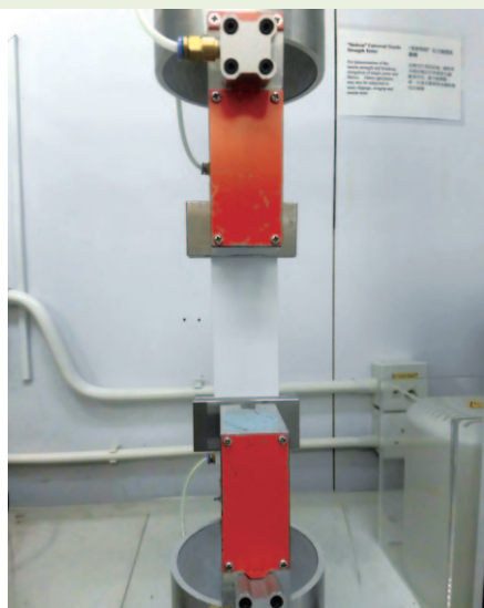
用儀器兩邊拉扯面紙樣本，測試樣本的乾紙拉力強度。
