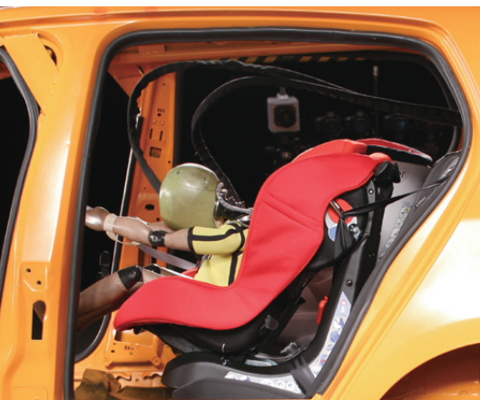
將假人放入安全座椅樣本進行正面撞擊測試。
