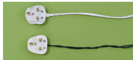
無牌子燈串的電線或部分電線只有基本絕緣保護，並不符合標準對接線的雙重絕緣要求。圖上方為符合標準要求的雙重絕緣保護電線，下方為只有基本絕緣保護的電線。
