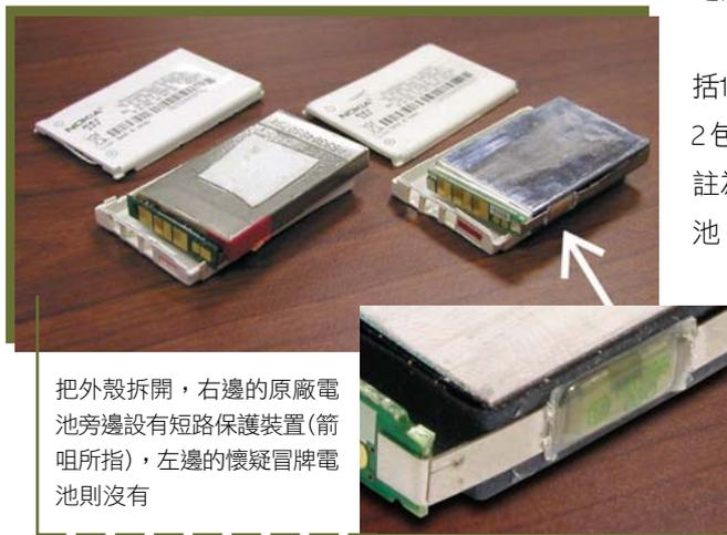
把外殼拆開，右邊的原廠電池旁邊設有短路保護裝置（箭咀所指），左邊的懷疑冒牌電池則沒有
