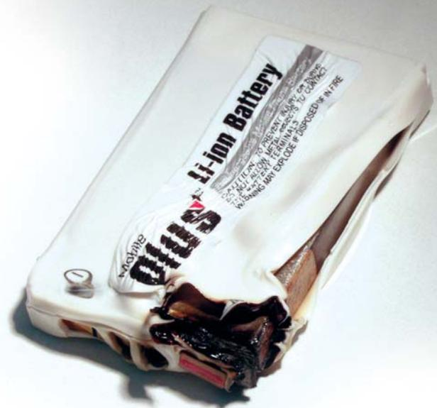
「Mobile Plus」樣本短路時產生的熱力令電池外殼溶解
