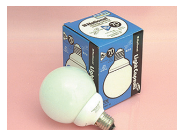
9. National 樂聲牌 Light Capsule EFT15E67 Cool Daylight Color 重128克 / 長133毫米 / 燈泡直徑90毫米 / 大螺絲頭
