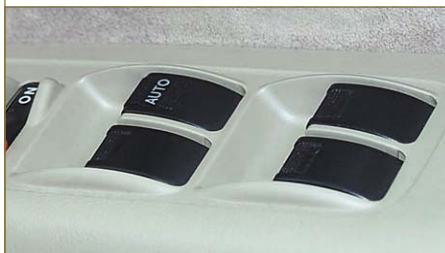
槓桿開關掣 (Lever Switches) - 把開關掣向上拉，車窗關閉；向下按時，車窗打開
