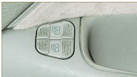
翹板開關掣 (Rocker Switches) - 向開關掣的一邊按下，車窗關閉；向另一邊按下，車窗打開
