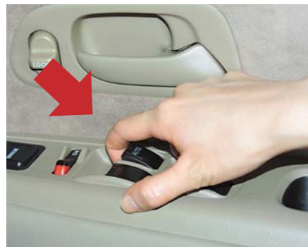
槓桿開關掣 (Lever Switches) 在3類電動車窗掣中最為安全，必須把開關掣向上拉，才可關閉車窗，減低被誤按關窗的機會
