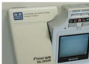
「京瓷」 Finecam SL300R機身 左右部分可以 調節角度
