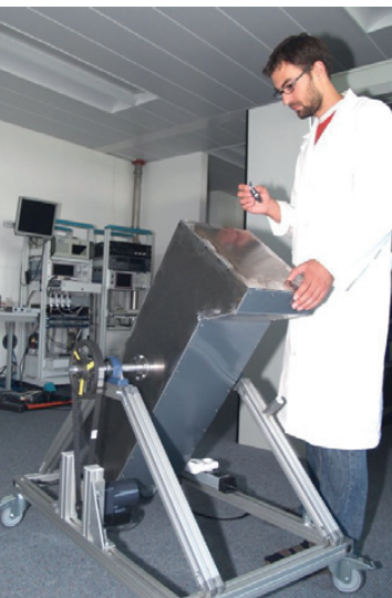
▲測試人員利用滾桶測試樣本的防跌撞能力。
