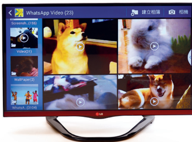
大部分較新款及規格較高的智能手機都支援 Miracast，可透過 Wi-Fi Direct 輸出到電視機，省卻駁線的麻煩。
