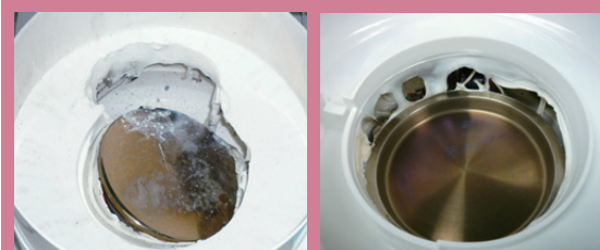
樣本 #14 (左) 及 #15 (右) 的部分接線錯誤連接，在非正常操作下，導致部分零件過熱燃燒及部分塑膠外殼變形破爛。
