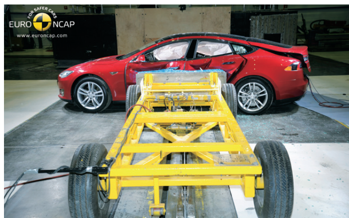
進行側面撞擊測試時，以時速 50 公里將車架撞向樣本車側。
