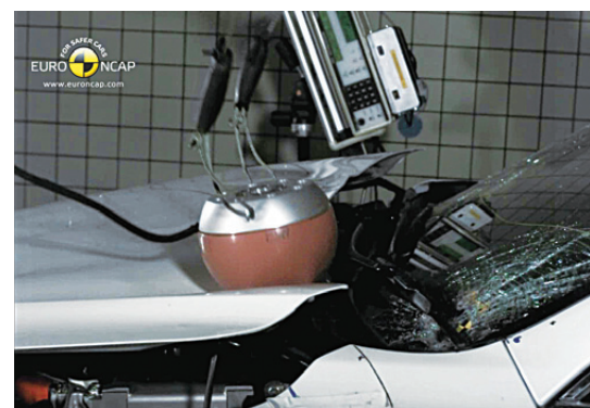
用儀器將假頭撞向樣本的车頭蓋，評估樣本對行人頭部的保護。
