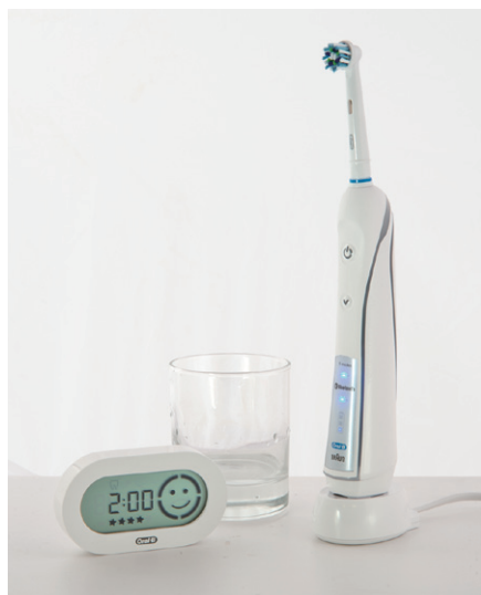
電動牙刷樣本內置 2 分鐘計時器，某些型號更每 30 秒會提示用者轉換刷牙部位。
