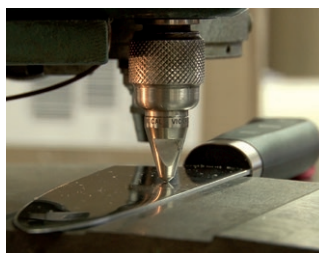
利用儀器量度刀身表面的硬度。
