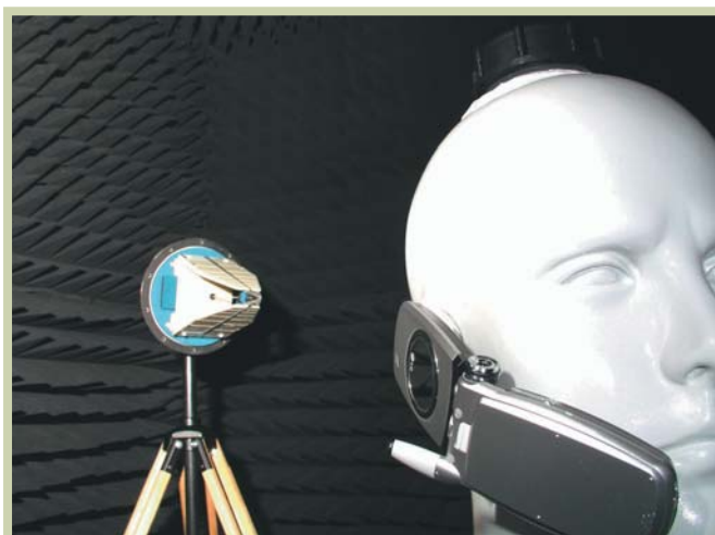
量度於不同功率輸出時手機的射頻量，所得資料用於推算出「普通情況」比吸收率
