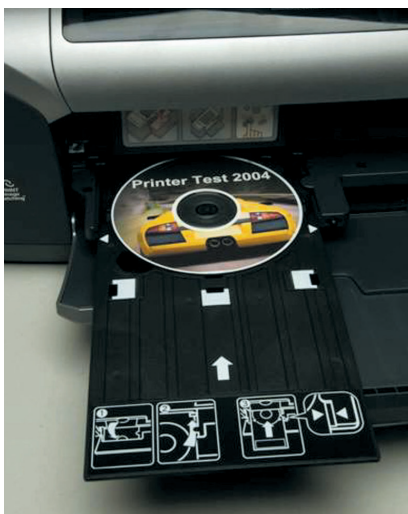
部分噴墨樣本有打印光碟功能，只要放進表面有印染表層的光碟即可。
