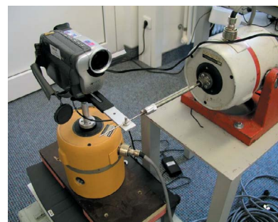
實驗室測試影像穩定性的震盪器。
