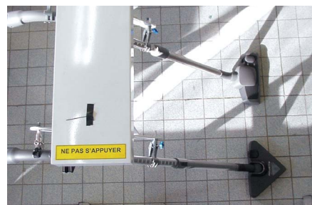
耐用程度測試中機械儀器推動吸扒，摩擦地面。
