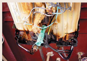
個案2中的電熱水爐，部分結構被燒至焦黑及熔化。
