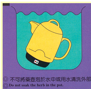
部分樣本警告清洗不可浸水，但圖畫上部沒有「X」符號，用戶可能誤解可用水洗。
