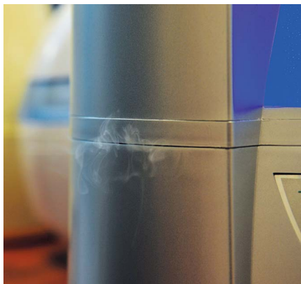
▲當#8的出霧口關掉時,霧氣從邊緣緩緩流出,可能在外殼凝聚成水點。
