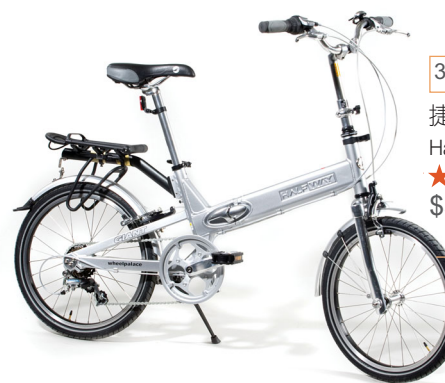
▲較傳統的摺合方法，鉸位在車架的中間位置，收藏時將單車前後對摺。
