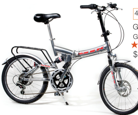
▲另一種摺合方法，車架呈三角形，在車架的頂端設有鉸位，收藏時將車架的前後支柱摺合。
