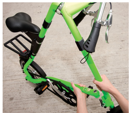
▲另一種摺合方法，車架呈三角形，在車架的頂端設有鉸位，收藏時將車架的前後支柱摺合。
