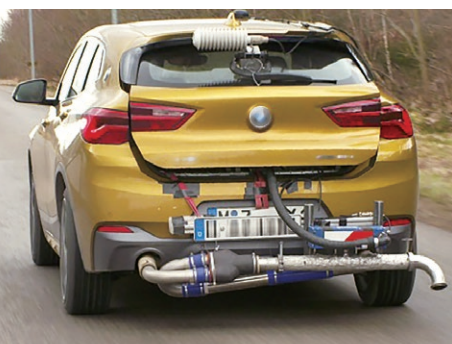
利用可攜式量度裝置量度樣本實際駕駛時的污染物排放量。
